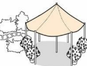
Pabellón compuesto de una estructura tensada hexagonal
